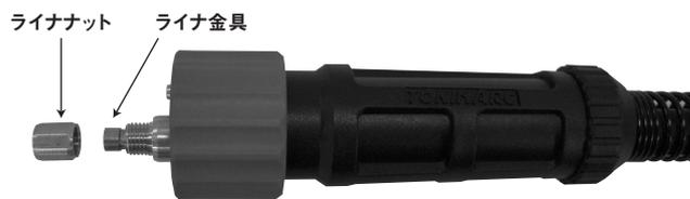
ライナ金具が写真の位置になるようにセットしてからライナナットをねじ込みライナを固定してください。ライナナットは手で軽く締め付けるだけで固定できますのでスパナ等の工具は使用しないでください。
