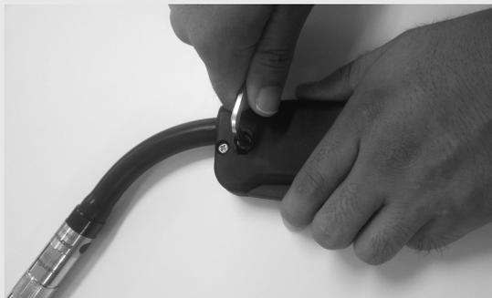
トーチボディを奥までいっぱい差し込んでから締付ボルトで固定してください。締付が不十分ですと発熱の原因となります。Oリングにひびわれ、きれが生じた場合には交換してください。ガスもれの原因となります。
