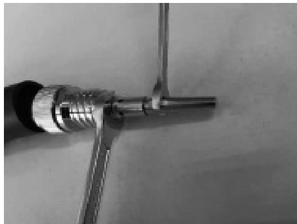
④ スパナ (12) をチップアダプタに掛けてチップアダプタが緩まないようにしてチップを外します。
