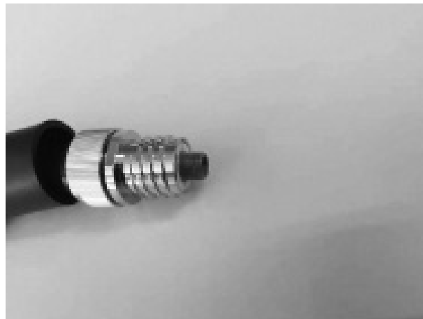
⑥ チップアダプタを取り外して、ネジ部にスパッタが付いていない様に清掃してください。
