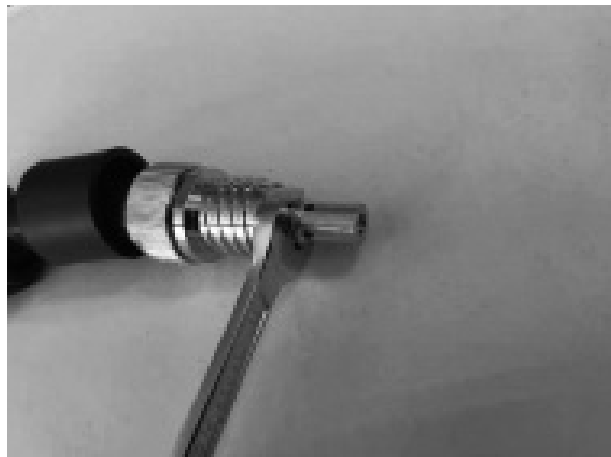
⑤ チップアダプタを交換する場合は、スパナ (12) でチップアダプタを外してください。
